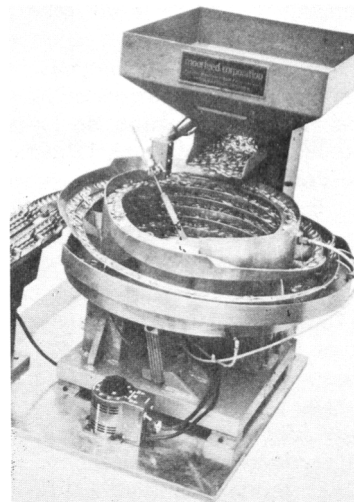
Fig. 4.16 Bol vibreur pour le positionnement de pièces stockées en vrac
